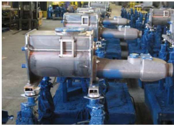
Bild 2 Ausgeschweißte Schalldämpfer auf Trollies vor dem Lackieren.
